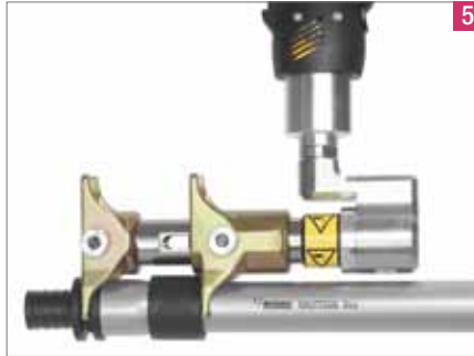
Sıkıştırma başlığının yerleştirilmesi
